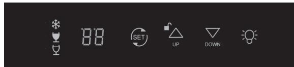
UPボタン を長押しすると、ロックが解除され、温度設定ボタンの上げ下げができるようになります。
